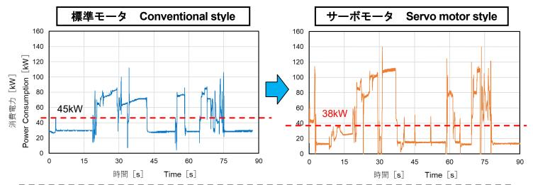
圧力保持・アイドリング中の圧力フィードバック制御により、大幅な省エネ効果
