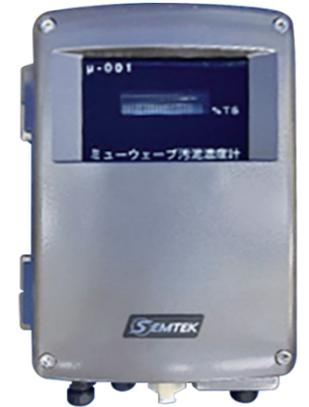
清水(濃度0%)でのマイクロ波透過波の位相遅れと、汚泥でのマイクロ波透過波の位相遅れとの差(位相差)が、汚泥濃度と直線関係にあることを利用して濃度を測定します。
