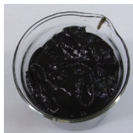
濃縮消化汚泥
