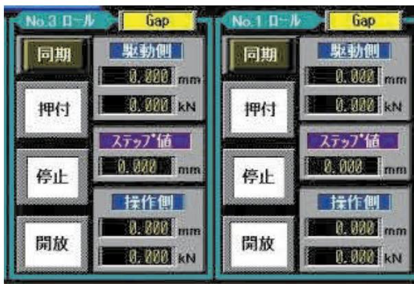
Fig. 7 油圧サーボシステムの操作画面
