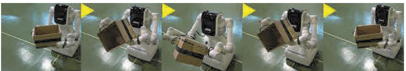
Fig. 8 CONOID-III実機による段ボール箱 ひっくり返し動作
