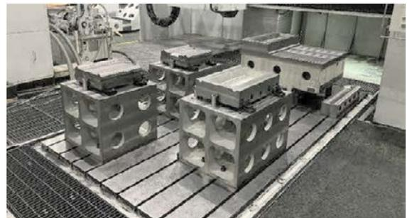
Fig.7 専用治具の外観写真
