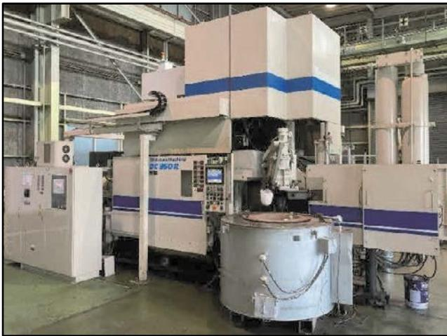
Fig. 2 型締力 3500kN ダイカストマシン
