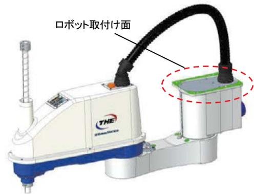
Fig. 4 THE800 天吊仕様の外観
