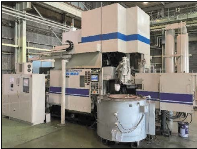
Fig. 2 型締力 3500kN ダイカストマシン (サーボ油圧源、増圧 ACC 仕様)
