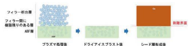
Fig.12 ドライアイスブラストによるフィラー除去により密着性が向上するメカニズム
