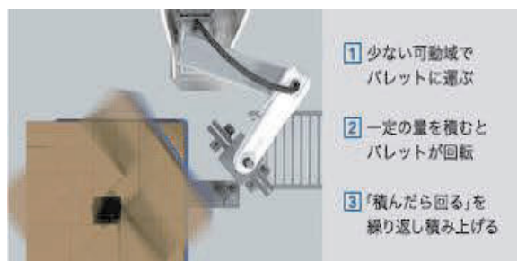
Fig. 3 積み上げ動作手順
