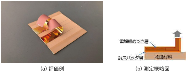
Fig. 6 ピール試験評価例と測定概略図
