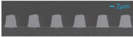
Fig. 14 LS=5/5 μm部分の断面SEM像
