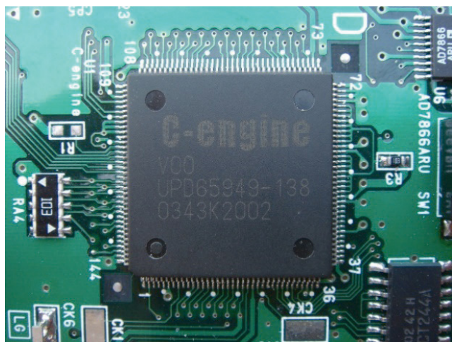
Fig. 11 開発した電流制御LSI C-engine
