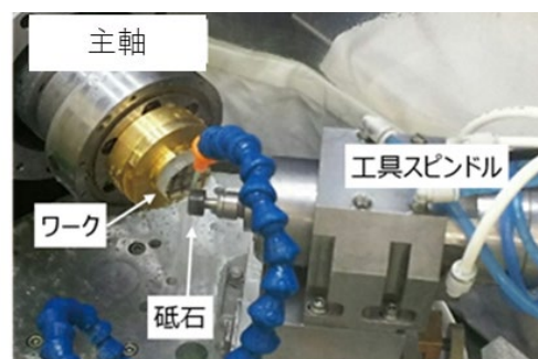
Fig. 4 自動アタリ確認機能のシステム構成
