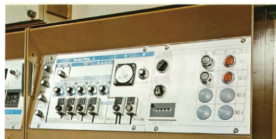
Fig. 13 プログラム射出制御装置 インジェクトロール® (INJECTROL®)
