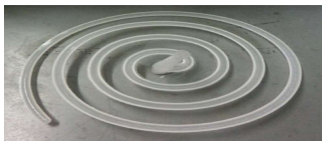
Fig. 3 スパイラルフロー試験の成形サンプル
