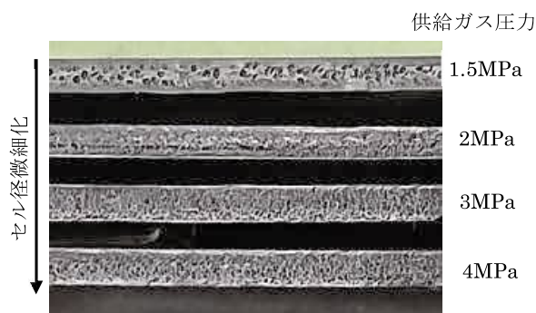
Fig. 12 供給ガス圧力と発泡成形品断面の変化
