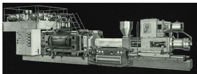
Fig. 11 オーバーヘッドタンク式のIS630AN
