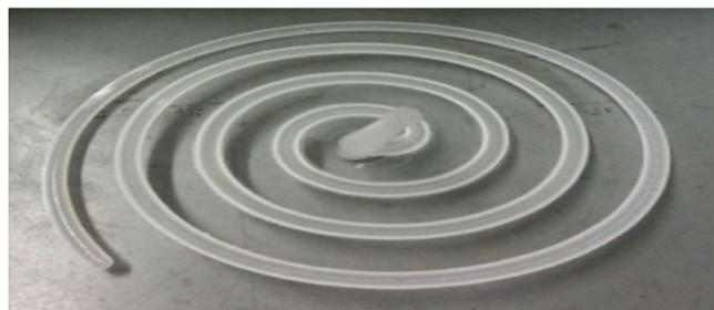
Fig. 3 スパイラルフロー試験の成形サンプル
