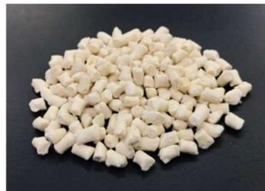
Fig. 1 CNF複合樹脂ペレット<sup>1)</sup>
