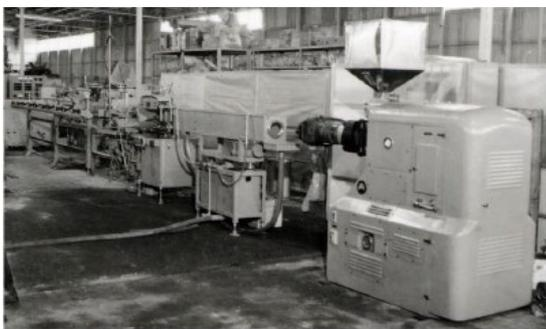
Fig. 1 押出成形機 初号機:65mm単軸機
