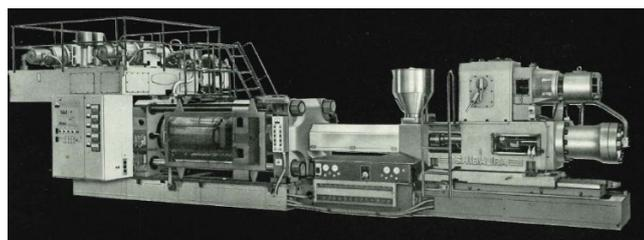
Fig. 11 オーバーヘッドタンク式のIS630AN
