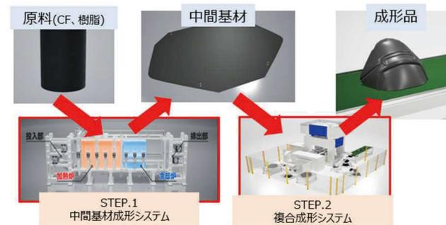
Fig. 4 CFRTP成形プロセス全体図
