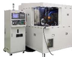
工作機械の一種であり、当社の超精密加工機は光学系や医療系などナノメートルレベルの超高精度加工が必要な部品の切削・研削などの加工に適した機械装置。
