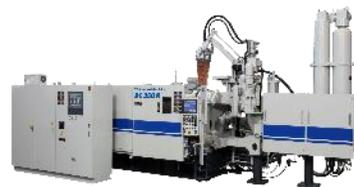
溶融させた金属(アルミニウム・マグネシウム)に高い圧力を加え、金型に注入することで製品を鋳造する機械装置。
