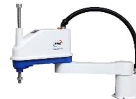
産業用ロボット：水平多関節(スカラロボット)、直交、塗装、垂直多関節ロボットなど産業用で使われる。
