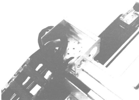
Y軸からのケーブルの長さを調整し、ケーブルを結束バンドで固定します。
