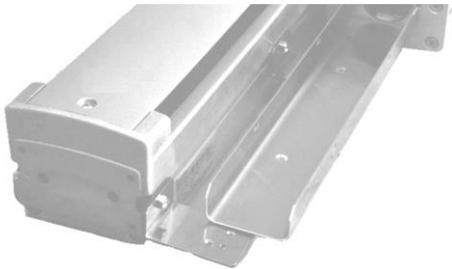
軸本体フレーム側面のT溝に、六角ナット（M4）を入れ、L型金具をフレーム側面に固定します
