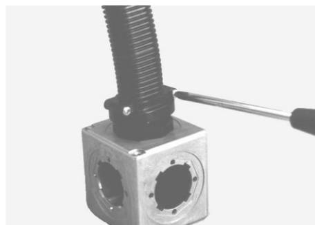
コネクタに挿入したチューブの根元部分に固定具をはめ込み、固定具のネジを締めて固定します。
