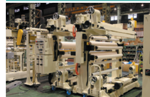
引取マスキング機 Take-up and masking unit
