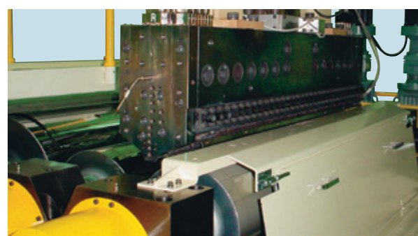
水平型ポリシング機 Horizontal type polishing roll unit
