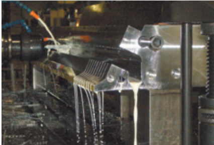
ダイスの加工 Machining of T-die
