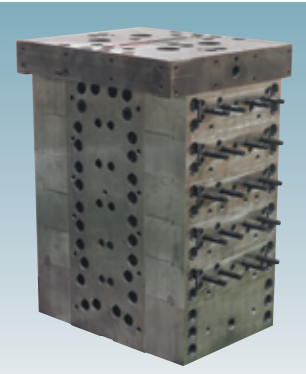
11層用フィードブロック 11 layers for feed block
