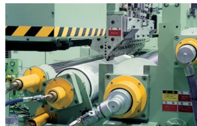
バックアップロール付タッチロール Touch roll with back-up roll
