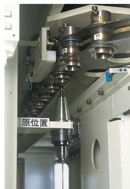
② 自動工具交換装置(ATC48本仕様)
