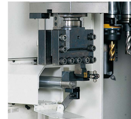
⑪ 自動刃先計測装置
