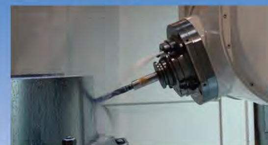
4軸ヘッドでの傾斜穴加工
