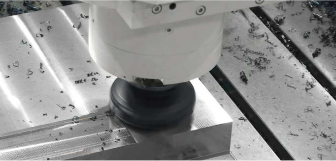
スナウト 220 正面フライス 削除量：704cm 3 /min
