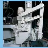
インバータ制御によりスムーズでしか も精度の高い注湯動作を可能にしま
