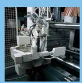
新リンク機構とインバータ制御の採 用により、スムーズな搬入、搬出動 作を可能にしました。
