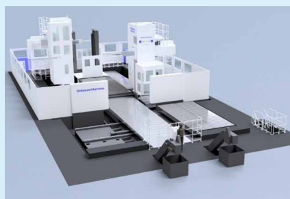
床上形横フライス中ぐり盤「BSF-150C」 2台による対向システム
