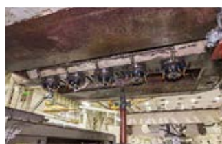
5つ同時に加工できるスイス製の機械。製造元では生産中止になり、レトロフィットで再生された。
