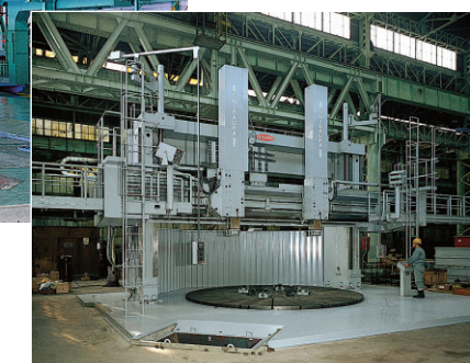
大型立旋盤 (改造例)
